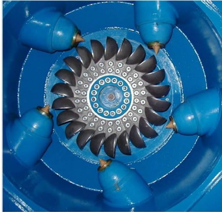
Figura 5.2. Turbina Pelton a 5 getti.
